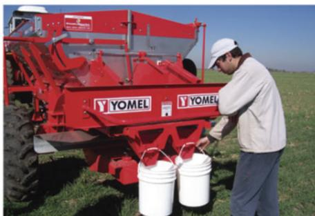
Dispositivo para calibración a campo de la dosificación que asegura exactitud en la dosis aplicada
