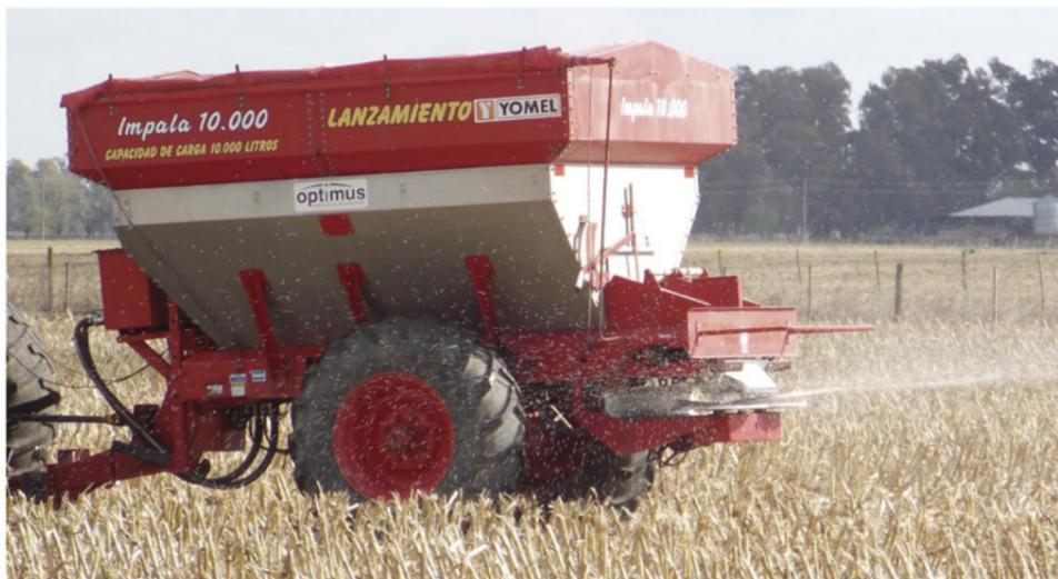
Las fertilizadoras Impala son equipos versátiles de gran capacidad de carga que permiten aplicar a dosis fija o variable fertilizantes granulados, enmiendas en polvos y semillas realizando una labor uniforme y precisa para la nutrición de cultivos y pasturas.
