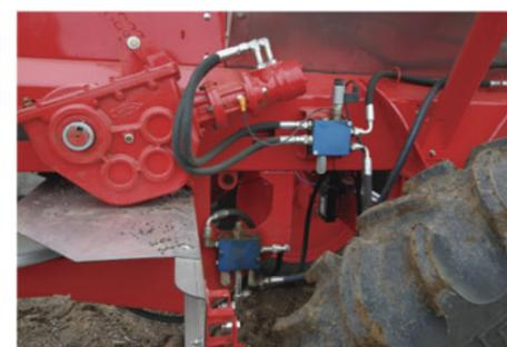
Tres opciones de equipamiento electrohidráulico para realizar aplicaciones a dosis variable predispuesta para la conectividad con cualquier computadora de fertilización del mercado:
