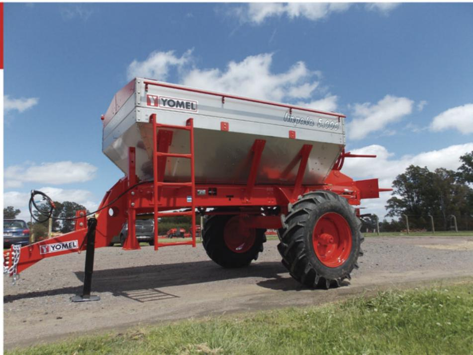
Tolva totalmente abulonada construida en acero inoxidable AISI 304 o chapa de acero 1010 pintada con fondo epoxi y horneada para resistir la acción abrasiva de los fertilizantes.
