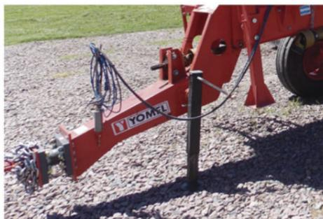
Enganche al tractor con brida de regulación para ajustar la nivelación de la máquina, lanza pivotante articulada por tacos de poliuretano y pie de apoyo de gran resistencia.
