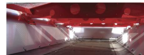
Dosificación a través de cinta transportadora de 80 cm de ancho fabricada en goma con 3 telas de alta resistencia, montada sobre cama con 15 rodillos con rodamientos blindados.
