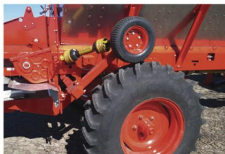
Accionamiento mecánico a través de rueda de mando que mantiene la dosis constante independientemente de la velocidad de avance.
