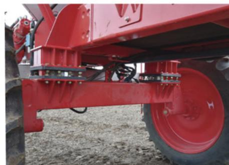
Todos los modelos se encuentran predispuestos para la instalación de balanza electrónica
