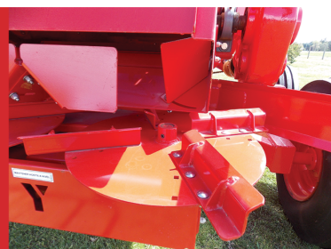
Distribución bidisco con 8 paletas reforzadas.
