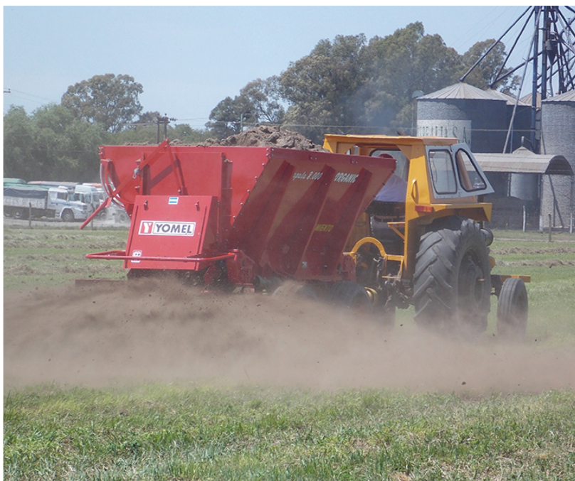
Distribución bidisco con 8 paletas reforzadas.
